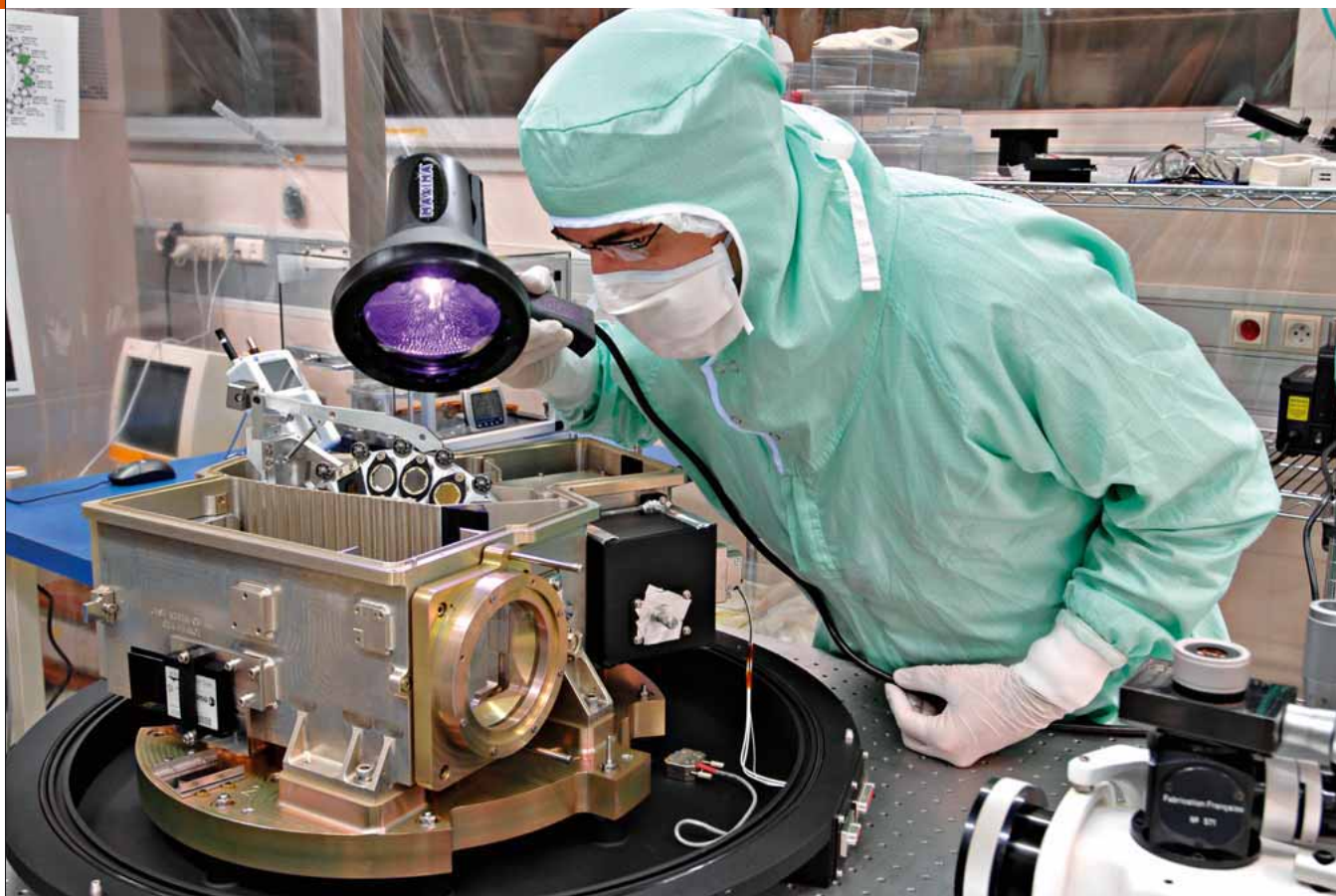
La caméra du Mid Infrared Imager (MIRIM), destinée au télescope JWST, en train d'être inspectée, sous éclairage ultraviolet, pour vérifier qu'il n'y a pas eu de contamination particulaire.
