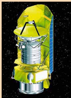
À droite : une vue d'artiste du satellite Herschel dont le télescope et l'instrumentation ont été placés au-dessus d'un réservoir d'hélium. À gauche : Herschel étudiera les sites de formation d'étoiles dans une gamme d'énergie inexplorée (image de Rho Ophiucius vue par le satellite ISO).
