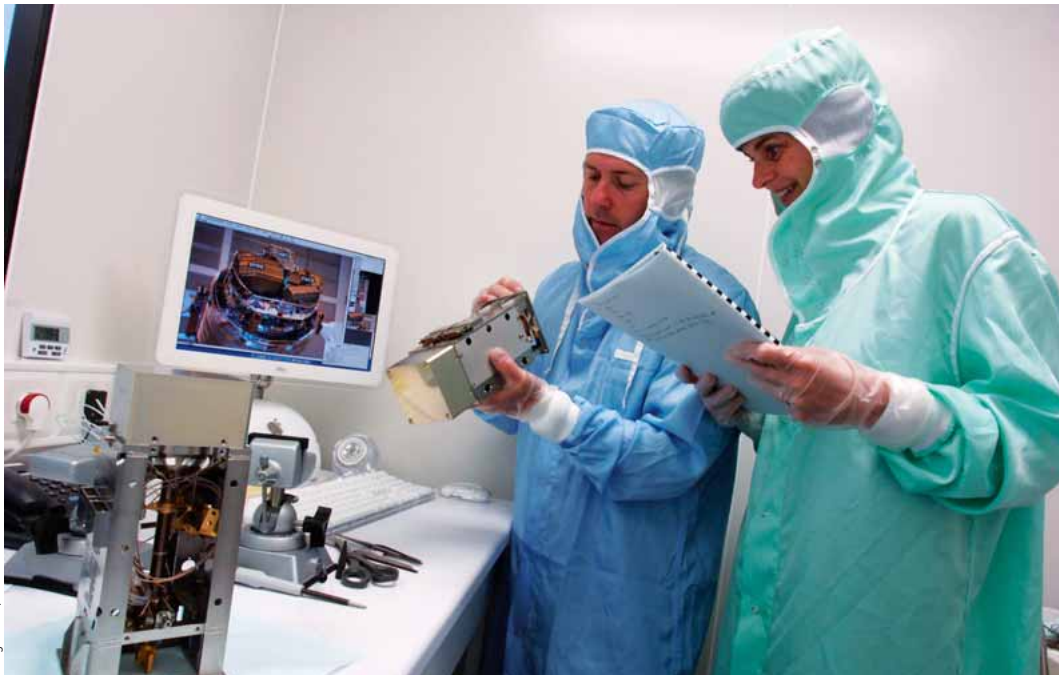
Il faut travailler sur la problématique du refroidissement des détecteurs embarqués sur les satellites, pour que ceux-ci marchent parfaitement durant au moins dix ans. Les cryoréfrigérateurs refroidissent les détecteurs à quelques centaines de millikelvins. Ici, essais thermiques sur le cryoréfrigérateur de rechange du satellite Herschel.
