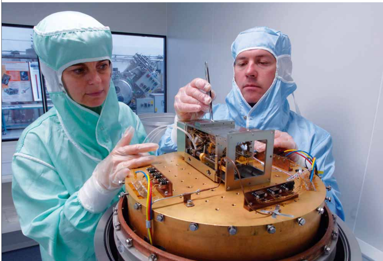
Installation d'un cryoréfrigérateur de vol sur le cryostat de test.
