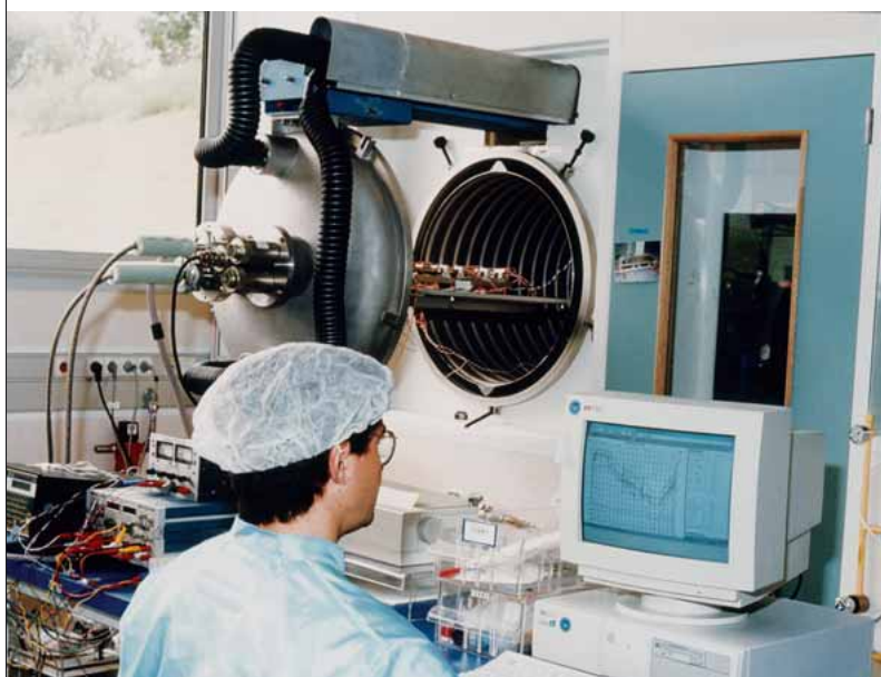
Après le décollage, le satellite se retrouve dans le vide de l'espace, livré à la chaleur du Soleil. Ces conditions peuvent être testées, en salle blanche, sur des modèles d'essais.
