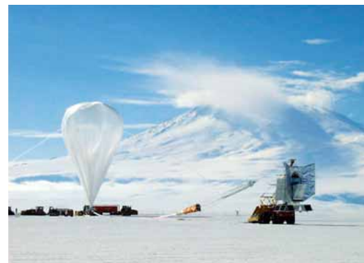
Figure 3. Lancement, depuis l'Antarctique, du ballon stratosphérique Boomerang, précurseur de l'expérience Olimpo. La détection du fond diffus cosmologique par Olimpo sera réalisée à l'aide de quatre plans de bolomètres placés au foyer d'un télescope de 2,6 m de diamètre.
